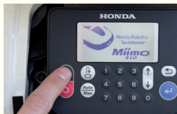
Selge ja hõlpsalt kasutatav juhtpaneel võimaldab vahetada Miimo režiime ja määrata turvakoodi
